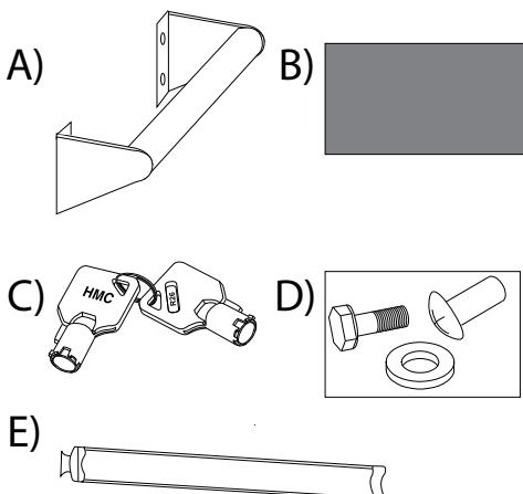
Utiliser 4 boulons pour fixer la poignée aux pièces de fixation soudées à l'intérieur.
