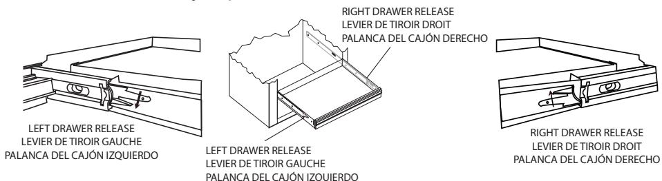
Para instalar el cajón de nuevo, insertar las correderas de los lados del cajón en las correderas de la unidad y cerrar completamente el cajón.
