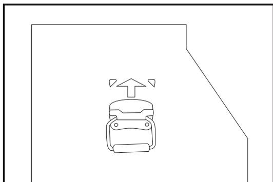
Deslice la manija para levantar (pieza A) sobre los pernos en cada lado del cofre superior y use dos tornillos (pieza D) para fijarla a cada lado del cofre superior
