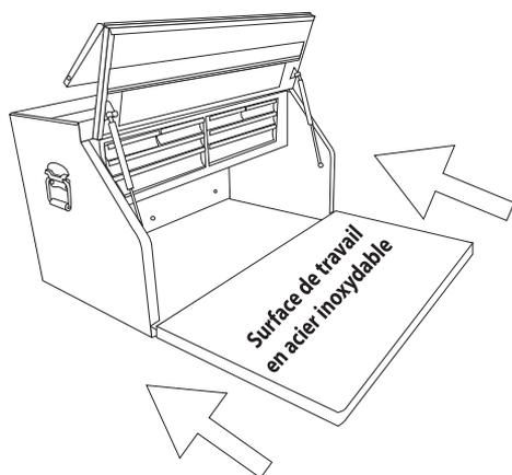
Pour installer la surface de travail en acier inoxydable (\*incluse avec le cabinet sur roulettes à fini noir satiné de 107 cm), deux personnes doivent faire glisser la planche dans les fentes dans la partie inférieure de l'armoire en pente.
