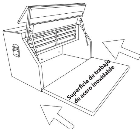
Para instalar la Worksurface de acero inoxidable (\*Incluida con el gabinete con rodillo y acabado satinado negro de 107 cm) use a dos personas para deslizar el tablón sobre las ranuras que están en la parte inferior de la cubierta.
