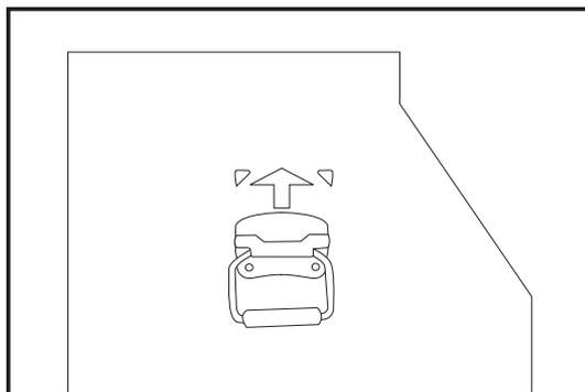
Faire glisser la poignée de levage (pièce A) vers le bas dans les fentes de chaque côté du coffre supérieur et utiliser deux vis du sac de pièces de fixation (pièce E) pour la fixer de chaque côté du coffre supérieur.
